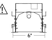
AVENUE 6 IS COMPATIBLE WITH ARMSTRONG<sup>®</sup> TECHZONE<sup>®</sup> AND OTHER SPECIALTY 6" CEILING SYSTEMS. TEE SPACING SHOULD BE 6" ON CENTER FOR ALL CEILING SYSTEMS.
