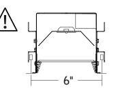
AVENUE 6 IS COMPATIBLE WITH ARMSTRONG<sup>®</sup> TECHZONE<sup>®</sup> AND OTHER SPECIALTY 6" CEILING SYSTEMS. TEE SPACING SHOULD BE 6" ON CENTER FOR ALL CEILING SYSTEMS.
